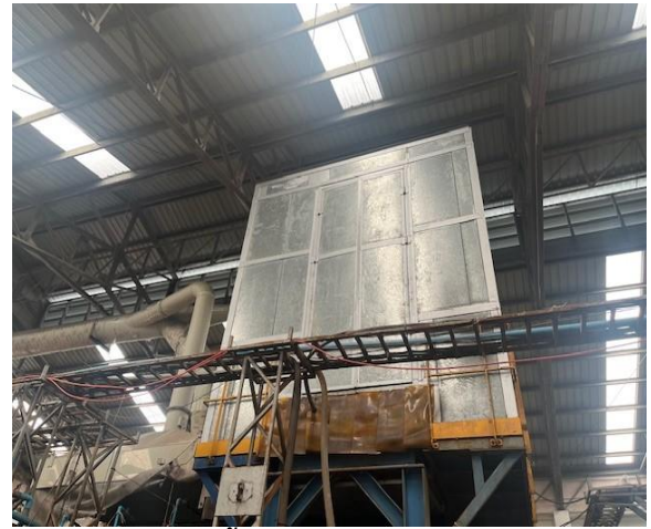
รูปที่ 2.1-9 ห้องเก็บ Battery Breaker เพื่อลดเสียงจาก แหล่งกำเนิด
