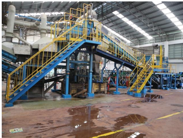
รูปที่ 2.1-2 ชุด Battery Breaker System
